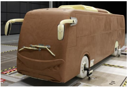
(b) 去掉前导流罩和前天窗顶罩
