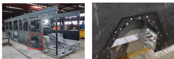
图4 碳纤维车身螺栓孔位图
