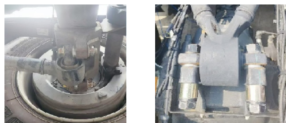
(a) 下推力杆增加 12 mm 垫片 (b) 上推力杆增加 8 mm 垫片
