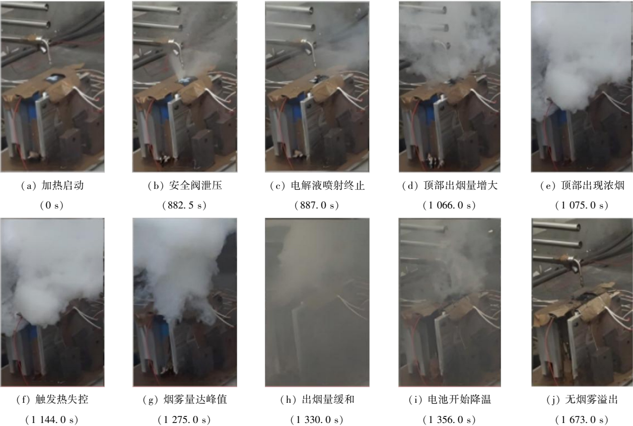
图 4 锂离子电池热失控过程现象时序图
