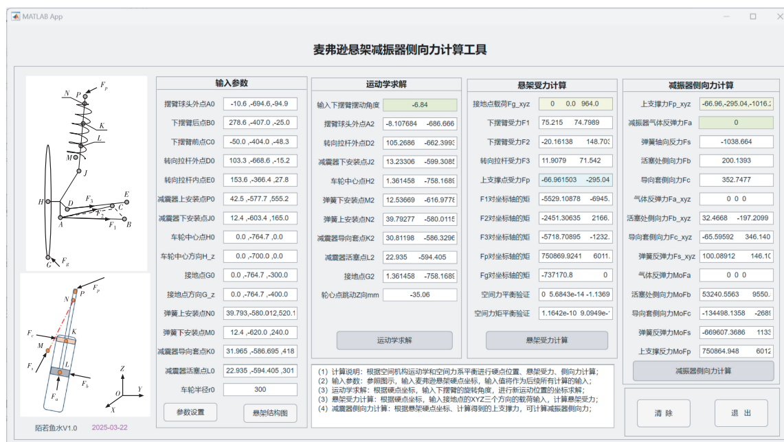
图6 麦弗逊减振器侧向力计算工具
