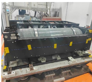
图 10 车载氢系统振动测试
