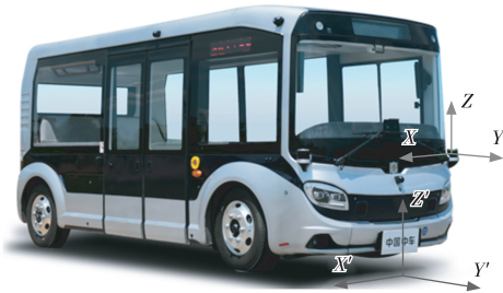
图 1 激光雷达坐标系与车辆坐标系示意图
