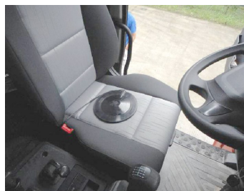
图5 驾驶员座椅实际测点布置
