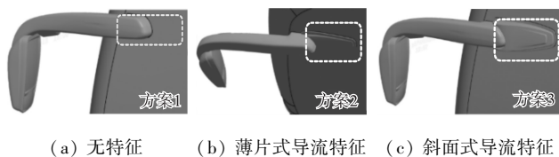
图5 后视镜安装座三种导流特征方案
