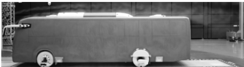
图 8 风洞烟流试验照片
