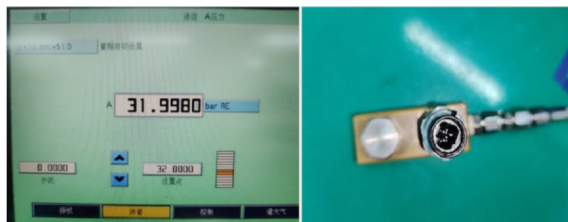
图3 压力传感器泄漏测试
