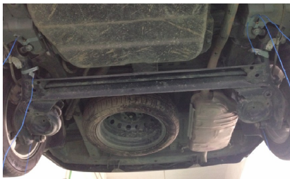
图 2 扭力梁模态测试图片
