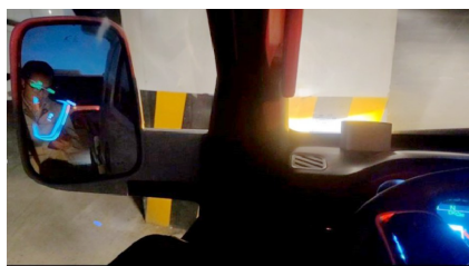
图2 显示屏在侧窗玻璃上的反光成像并遮挡外后视镜直接视野
