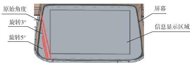
图5 显示屏不同角度下的反光
