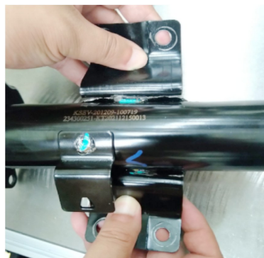
图 9 台架试验中螺栓预紧不足断裂图
