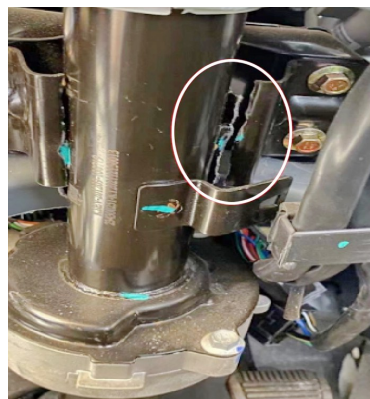
图1 断裂的转向管柱上护管支架
