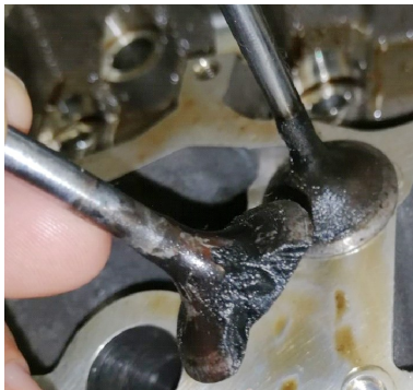
图1 排气门头部烧蚀
