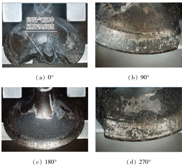
图3 5#气门不同角度烧蚀情况
