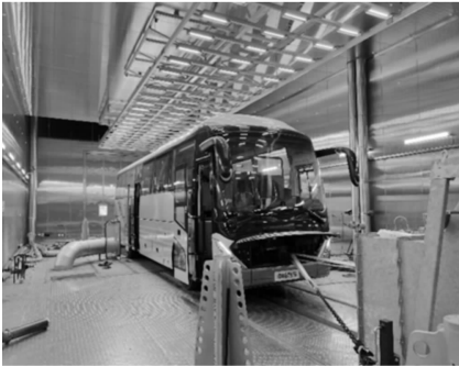
图 2 某客车环模舱内试验照片
