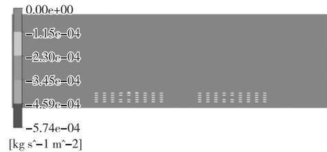
图 11 冷凝水析出速率(修正模型)
