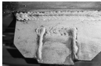
图 1 稳定杆底座纵向裂纹
