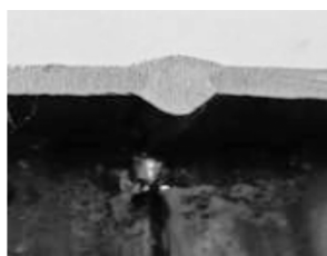
图12 型材对接焊缝 1 mm 间隙熔深
