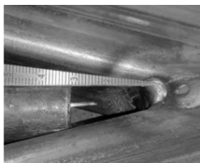
图3 30°斜撑焊接时 焊丝干伸长度
