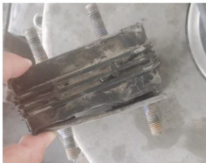
图2 压缩型悬置软垫撕裂图样
