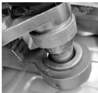
图8 螺柱焊枪在夹具内
