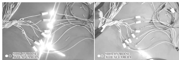
图6 发光二极管模拟瓶阀及主阀开关图示
