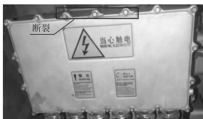
图1 振动试验结构件断裂位置
