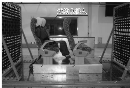
图4 新版标准强度试验第一阶段假人放置照片
