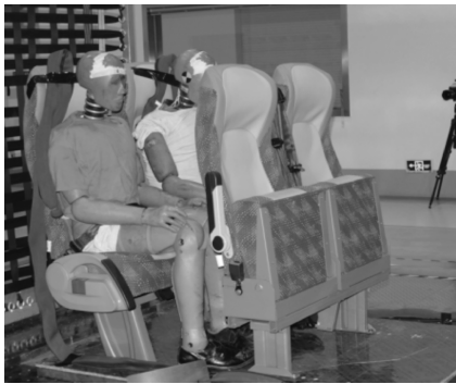
图 1 应急门处的折叠座椅(试验照片)
