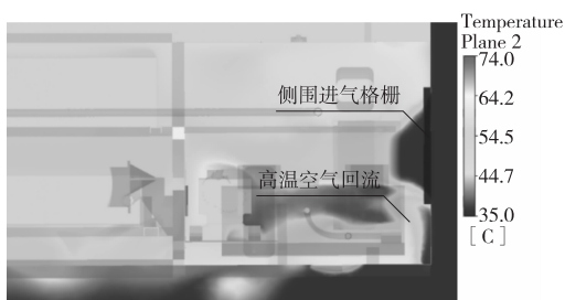
图7 散热器垂直方向中截面温度云图
