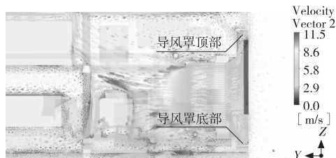
图11 散热器垂直方向中截面速度矢量
