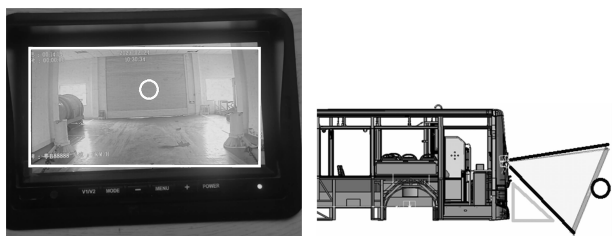
图 13 前方实车视野模型与模型视野
