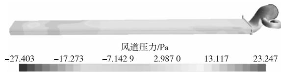
图6 风道表面压力云图
