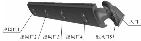
图4 风道结构示意图
