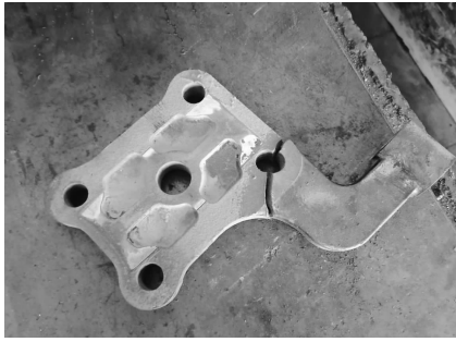
图2 减振器支座断裂
