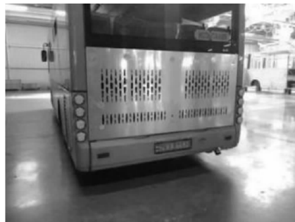
图7 更换带孔发动机舱盖板图
