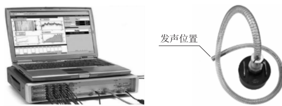
图2 LMS 测试系统(左)及体积声源(右)
