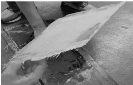
图6 DCPD 蒙皮表面裱糊层整片剥落状态
